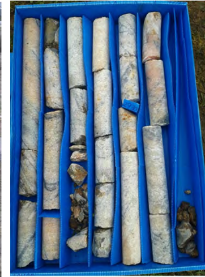
Fig. 4. Tubo porta testigos (izquierda) y testigos de roca obtenidos en la primera de las perforaciones (sondeo1) realizadas en el cerro del Castillo. Fotografías: W. Martín.
