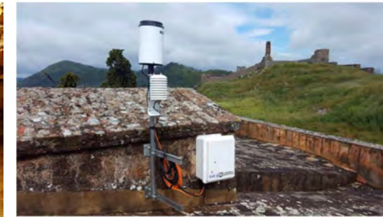
Fig. 9. Imágenes de las nuevas estaciones meteorológicas instaladas en el interior de la cavidad (izquierda) y el exterior (derecha). Fuente: Ayuntamiento de Aracena
