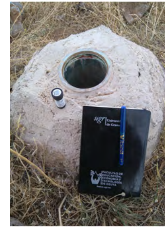
Fig. 8. Detalle del detector de radón y del sondeo que intercepta la cavidad descubierta (izquierda), y de su introducción e instalación (derecha). Fotografías: Martín-Gómez.
