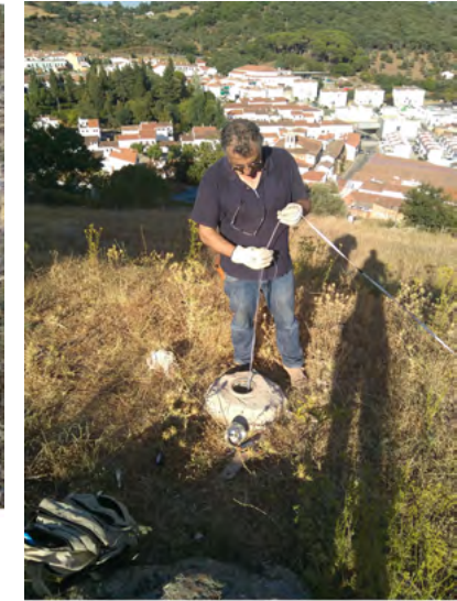
Fig. 8. Detalle del detector de radón y del sondeo que intercepta la cavidad descubierta (izquierda), y de su introducción e instalación (derecha). Fotografías: Martín-Gómez.
