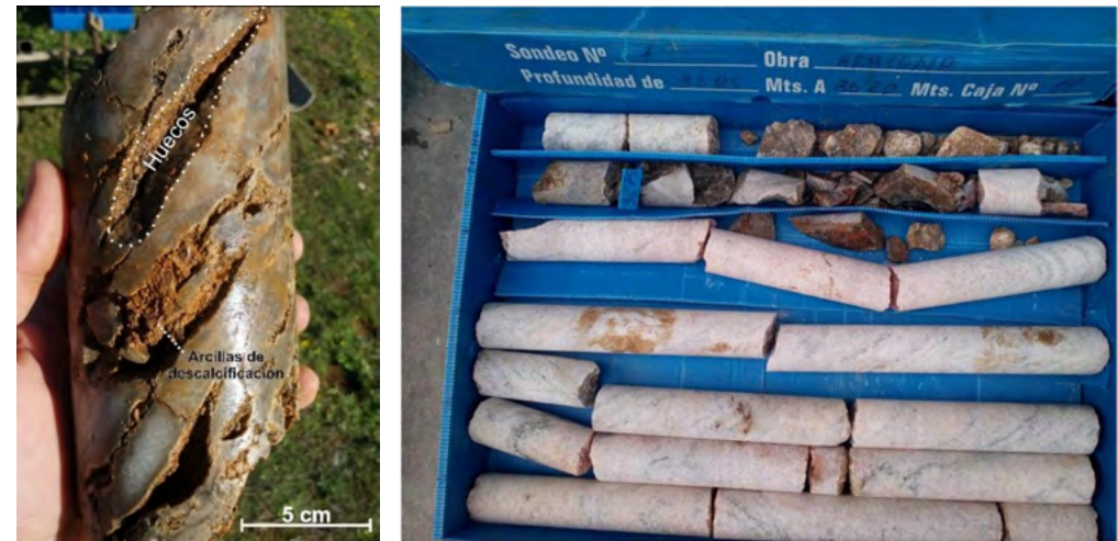
Fig. 6. Perforación del sondeo 1. Muestra de mano de cuarcita con venas disueltas y arcillas de descalcificación rellenando los huecos (izquierda). Detalle de los mármoles interceptados a profundidades comprendidas entre los 32 y 36 m (derecha). Fotografías: F. Martínez-Moreno
