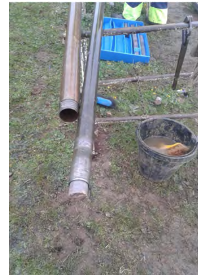
Fig. 4. Tubo porta testigos (izquierda) y testigos de roca obtenidos en la primera de las perforaciones (sondeo1) realizadas en el cerro del Castillo. Fotografías: W. Martín.
